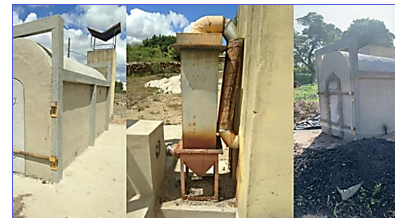
Figura 47 - Sistema de mini-fornos retangulares com condensador e queimador vertical de fumaça para produção contínua e sustentável de carvão vegetal, alcatrão vegetal e extrato pirolenhoso
