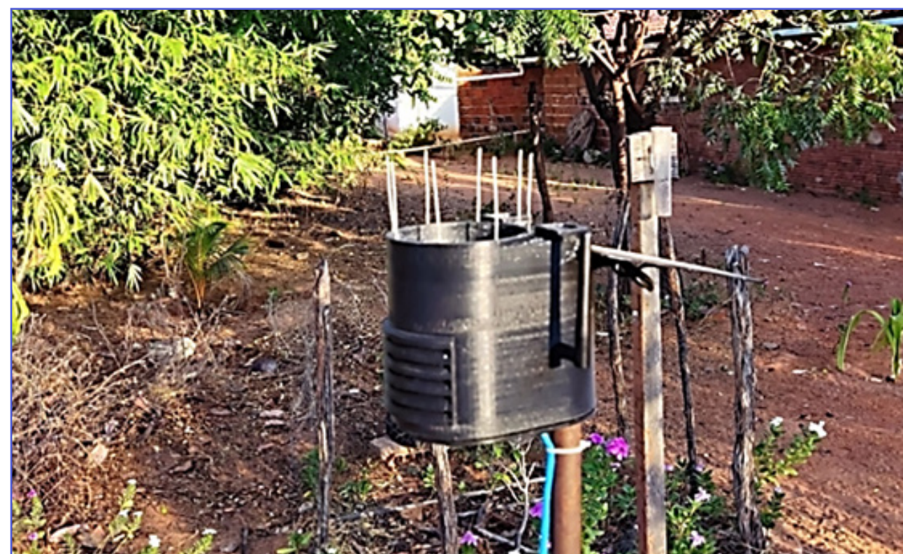
Figura 43 - Estação meteorológica wireless compacta modular
