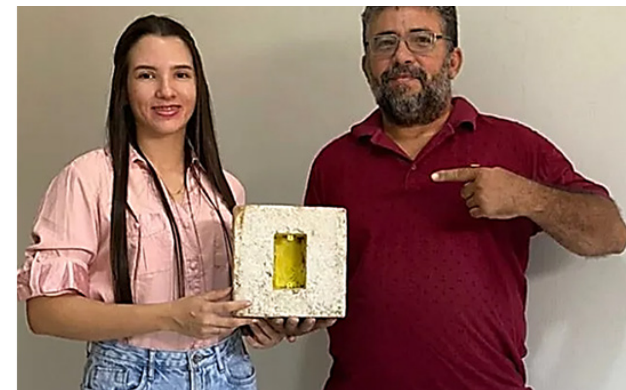
Figura 41 - Tijolo ecológico à base de papelão, pó de madeira e gesso
